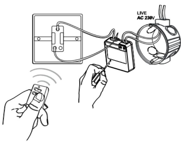
Das Funk-Modul ITL-230 kann hinter jeden vorhandenen Lichtschalter eingebaut werden und ist für alle Arten von Leuchtmittel (auch LEDs) bis max. 230 Watt geeignet.
